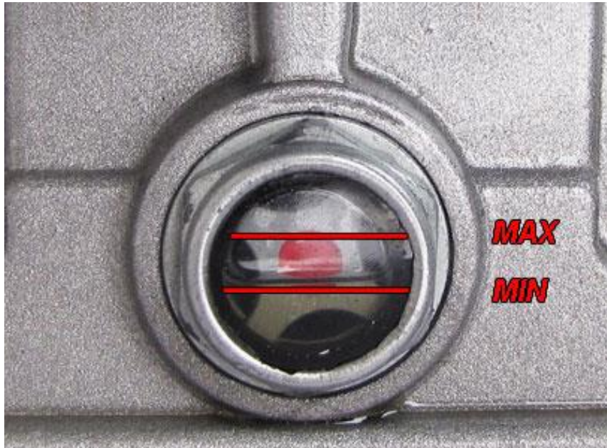
Rysunek 4 – Zalecany poziom oleju w agregacie
