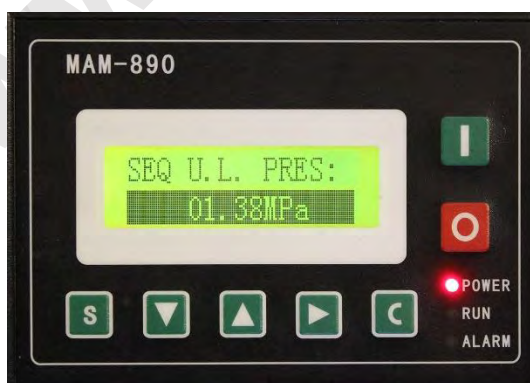
19. Kolejność wyłączenia w sieci
