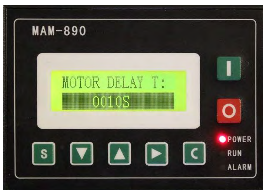
5. Czas opóźnienia uruchomienia silnika
