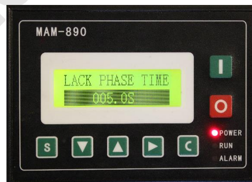
10. Zabezpieczenie czasu zaniku faz
