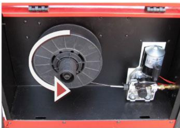
Rys 1. Kierunek obrotu szpuli z drutem spawalniczym (zdjęcie poglądowe)
