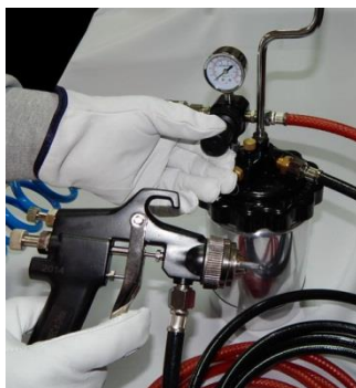
11. USTAW NA REDUKTORZE ODPOWIEDNIE CIŚNIENIE.
