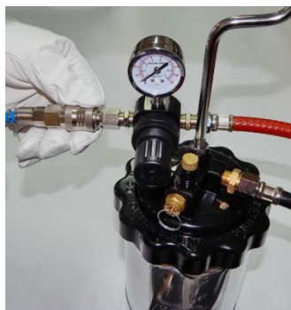
10. PODŁĄCZ SPRĘŻONE POWIETRZE Z KOMPRESORA.
