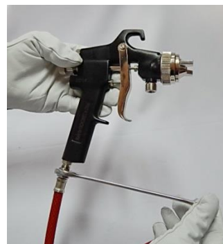
3.PRZYKRĘĆ WĄŻ POWIETRZNY DO PISTOLETU 1/4" w.
