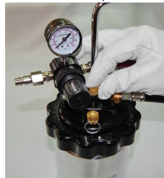
6.DOKRĘĆ ZAWÓR SPUSTU POWIETRZA NA ZBIORNIKU.
