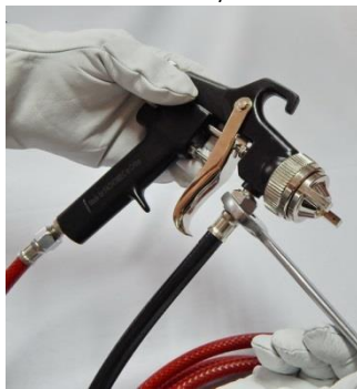
5.PRZYKRĘĆ WĄŻ MATREIAŁU DO PISTOLETU 3/8" w.
