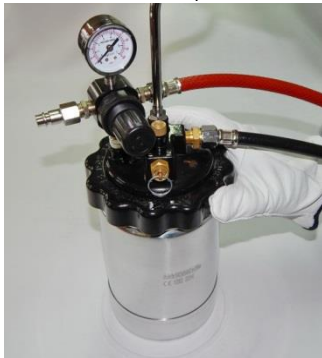
7.ODKRĘĆ NAKRĘTKĘ MOCUJĄCĄ POKRYWĘ ZBIORNIKA.
