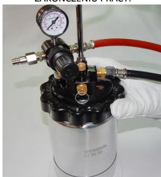
17. ODKRĘĆ NAKRĘTKĘ MOCUJĄCĄ POKRYWĘ ZBIORNIKA.
