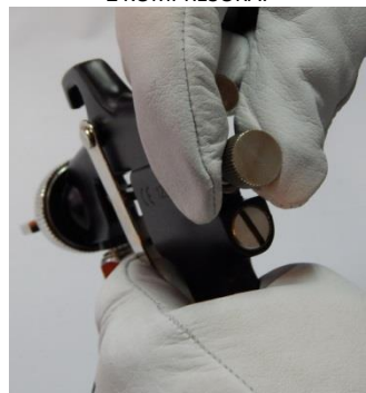
13. USTAW NA PISTOLECIE ODPOWIEDNI WYPŁYW MATERIAŁU.
