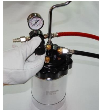
9.ZAMKNIJ ZAWÓR REDUKTORA POWIETRZA.
