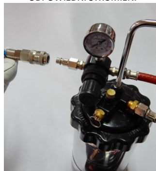
15. ODŁĄCZ SPRĘŻONE POWIETRZE OD ZBIORNIKA.
