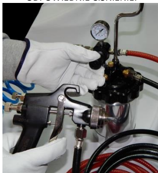
14. ZAKRĘĆ REDUKTOR PO ZAKOŃCZENIU PRACY.
