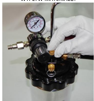
16. ODKRĘĆ ZAWÓR SPUSTU POWIETRZA NA ZBIORNIKU.
