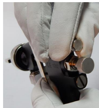
12. USTAW NA PISTOLECIE ODPOWIEDNI STRUMIEŃ.
