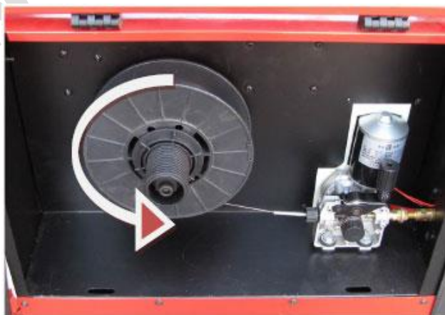
Rys 2. Kierunek obrotu szpuli z drutem spawalniczym (zdjęcie poglądowe)
