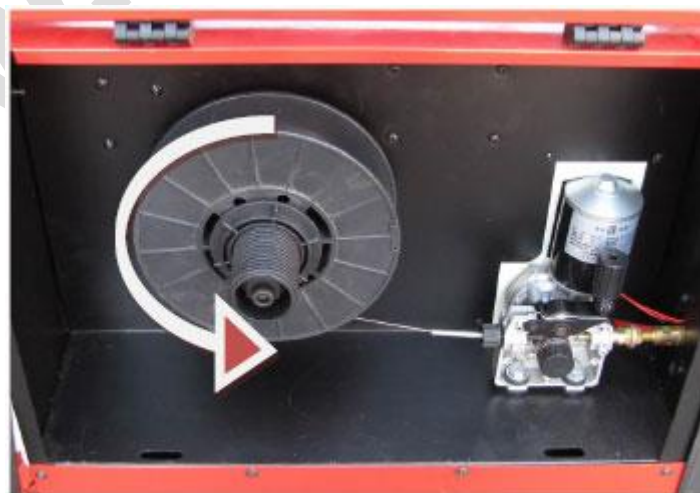
Rys 4. Kierunek obrotu szpuli z drutem spawalniczym – na przykładzie GRIN 195
