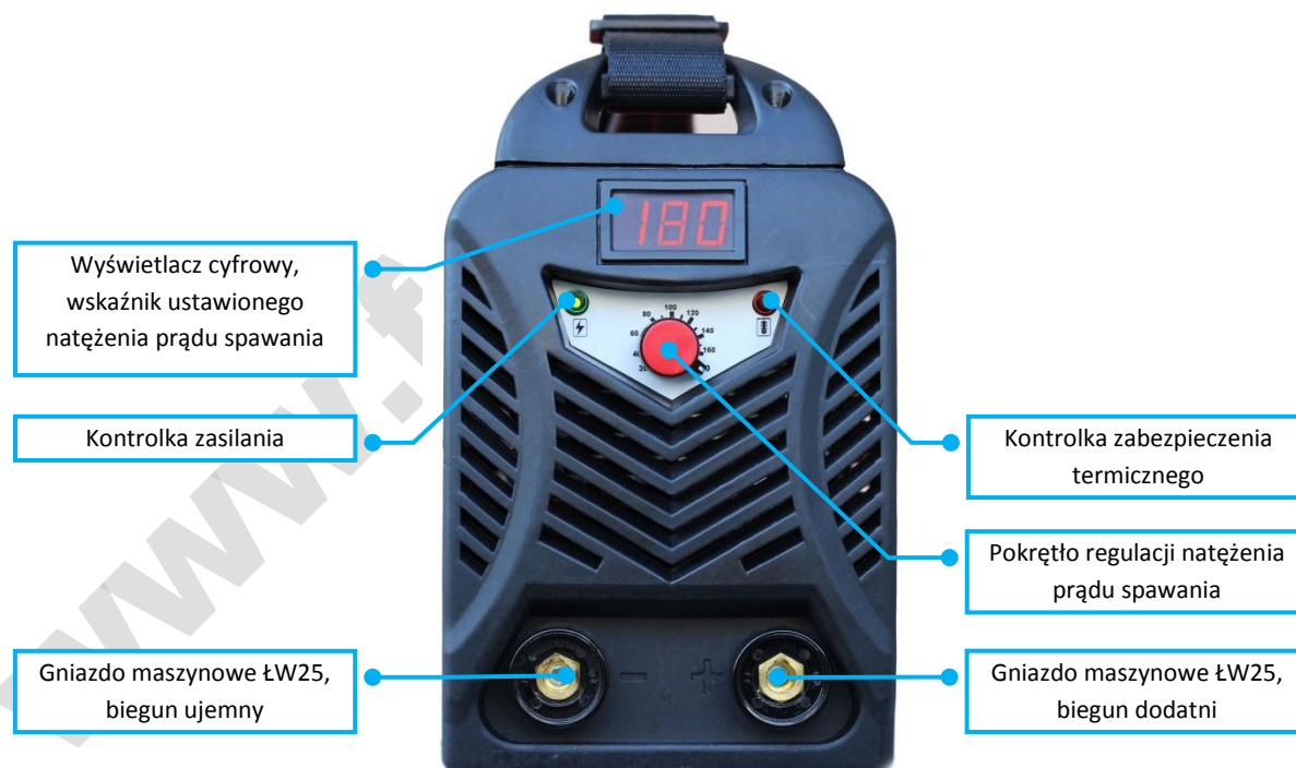
Rys 1. Halo 180 opis panelu przedniego
