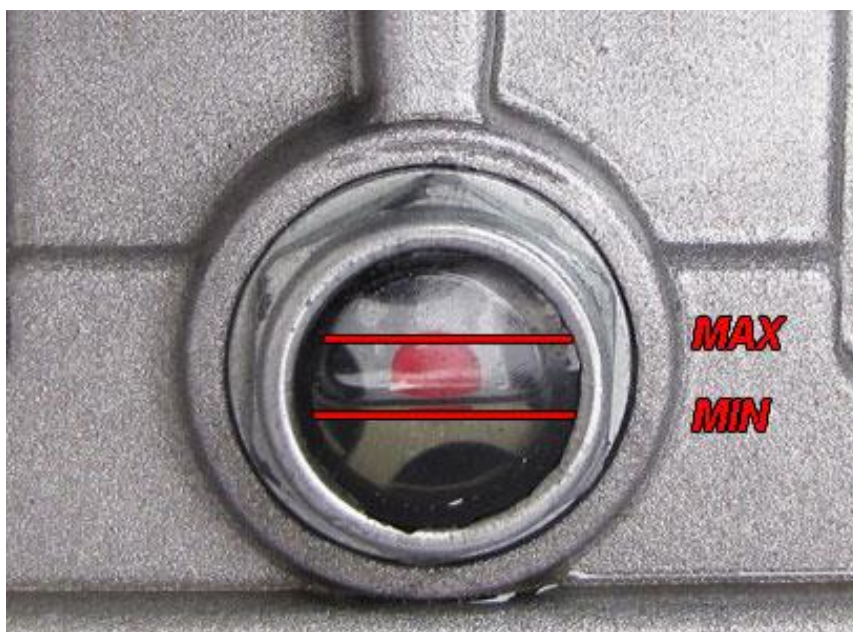
Rysunek 4 – Zalecany poziom oleju w agregacie
