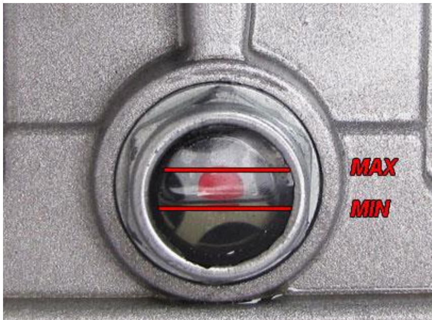
Rysunek 4 – Zalecany poziom oleju w agregacie
