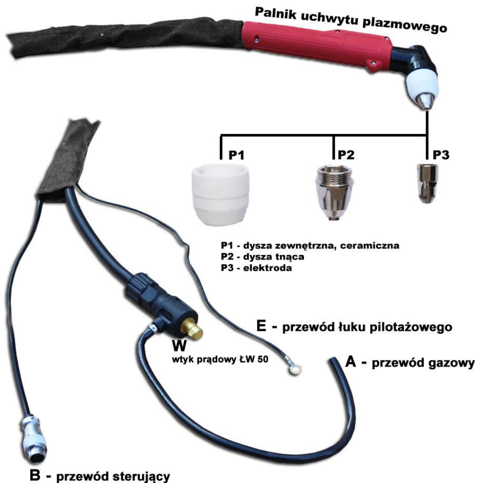
Rys. 20 Uchwyt plazmowy, schemat
