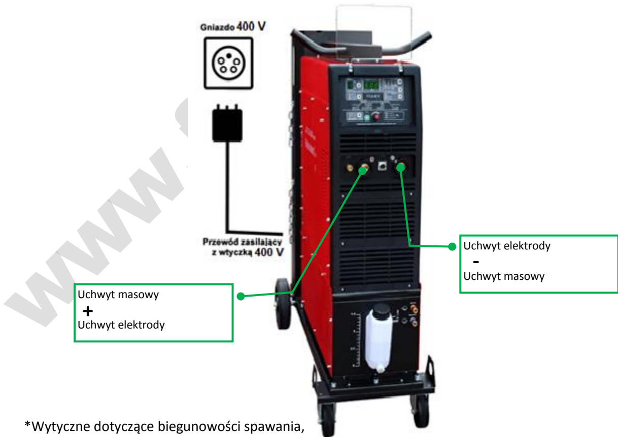
Rys. 15 Spawanie MMA: Schemat podłączenia JET TIG II 320, JET TIG II 400, JET TIG II 500
