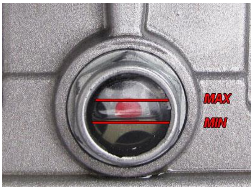
Rysunek 2 – Zalecany poziom oleju w agregacie
