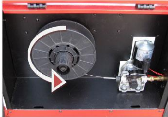
Rys 6. Kierunek obrotu szpuli z drutem spawalniczym
