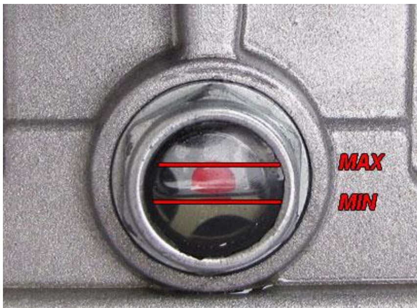
Rysunek 2 – Zalecany poziom oleju w agregacie
