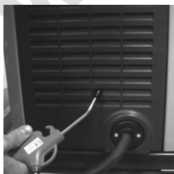
Przedmuchać front urządzenia
