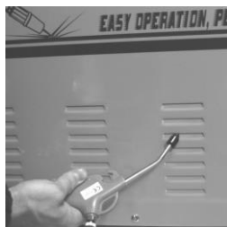
Przedmuchać boczne otwory wentylacyjne urządzenia
