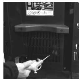
Dokładnie przedmuchać wentylator urządzenia
