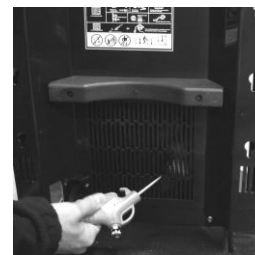
Dokładnie przedmuchać wentylator urządzenia
