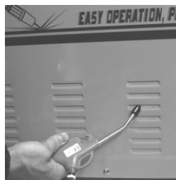
Przedmuchać boczne otwory wentylacyjne urządzenia
