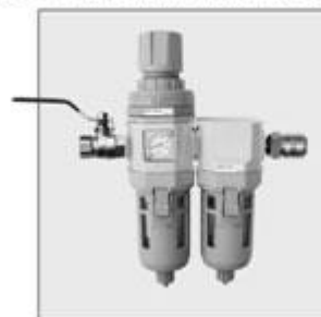
BLOK PRZYGOTOWANIA POWIETRZA FILTR WODY + REDUKTOR + FILTR MGŁY OLEJOWEJ
