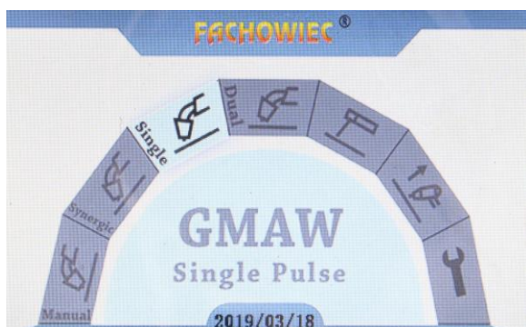
TRYB MIG/MAG SINGLE PULSE – spawanie prądem pulsującym
