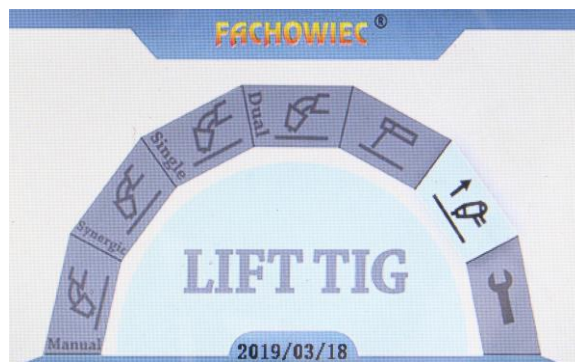
TRYB LIFT TIG – spawanie nietopliwą elektrodą wolframową w osłonie argonu. Zajarzenie łuku przez potarcie.
