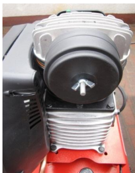
Filtr sprężarki w obudowie
