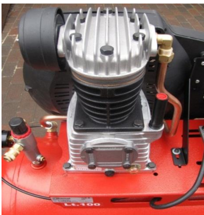
Agregat sprężarkowy z żeliwnym cylindrem
