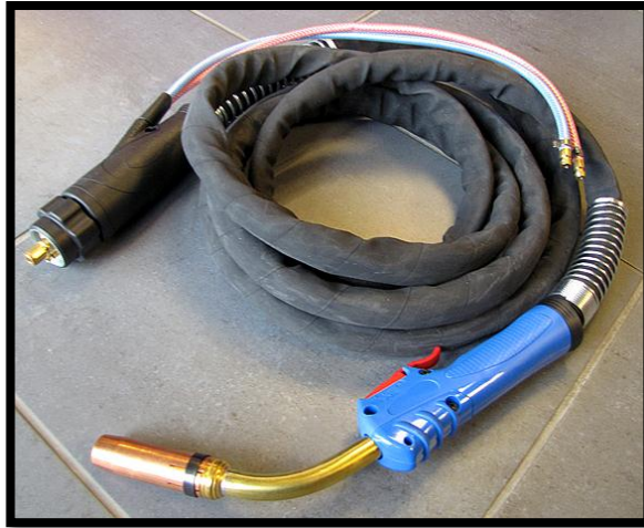
Uchwyt spawalniczy chłodzony cieczą, wyposażony w Eurowtyk.
